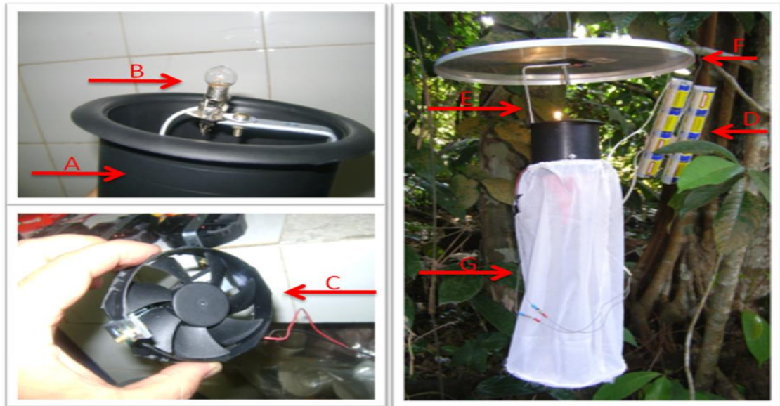
Figura 1: Detalhe dos componentes da armadilha: cilindro plástico (A); lâmpada (B); ventilador (C); pilhas (D); parafuso central (E); bandeja de proteção (F); saco coletor (G). (Fotos: S. L. Gianizella e A. W. de M. Gomes)
