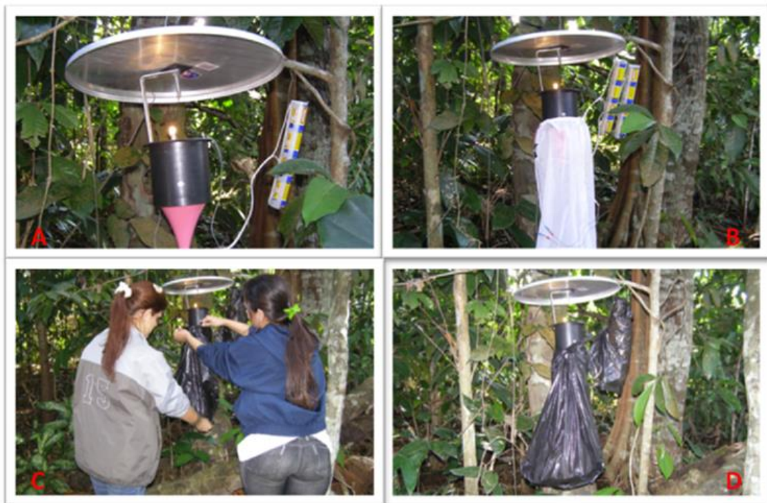
Figura 3: Montagem da armadilha em campo: (A) Acionamento dos receptores de pilha; (B) Manga de pano de organza sendo presa ao cilindro de plástico; (C) Saco plástico sendo colocado sobre o cilindro; (D) CDC montada em campo. (Fotos: S. L. Gianizella e A. W. de M. Gomes)
