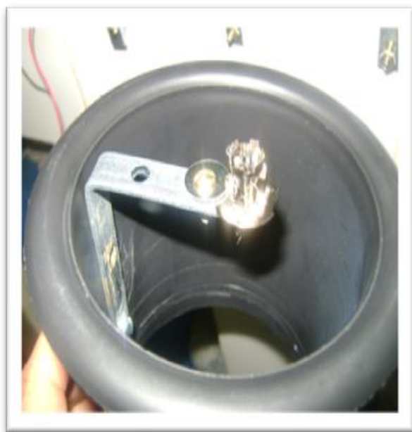
Figura 1: Cilindro de plástico e receptor da lâmpada de 3 W (Fotos: Sérgio Luis Gianizella).
