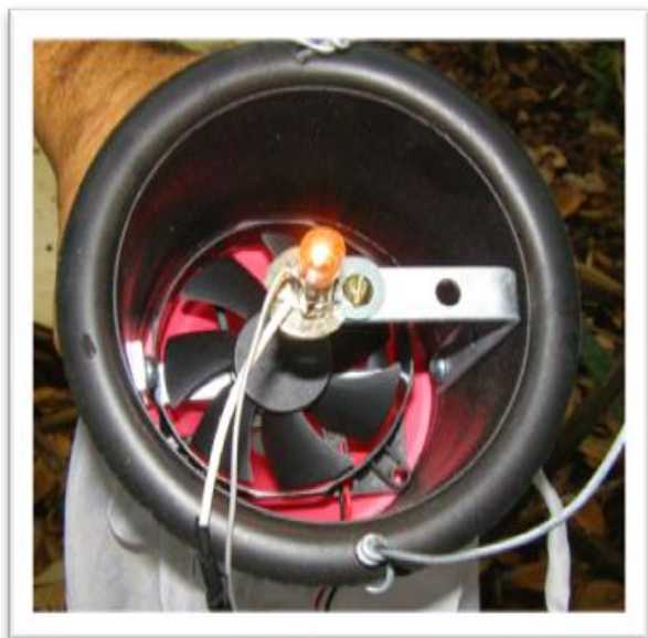
Figura 3: Detalhe do receptor com a lâmpada e ventilador armazenados no cilindro (Fotos: Sérgio Luis Gianizella).
