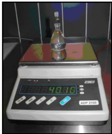
Figura 14- Obtenção da densidade do picnômetro com água
