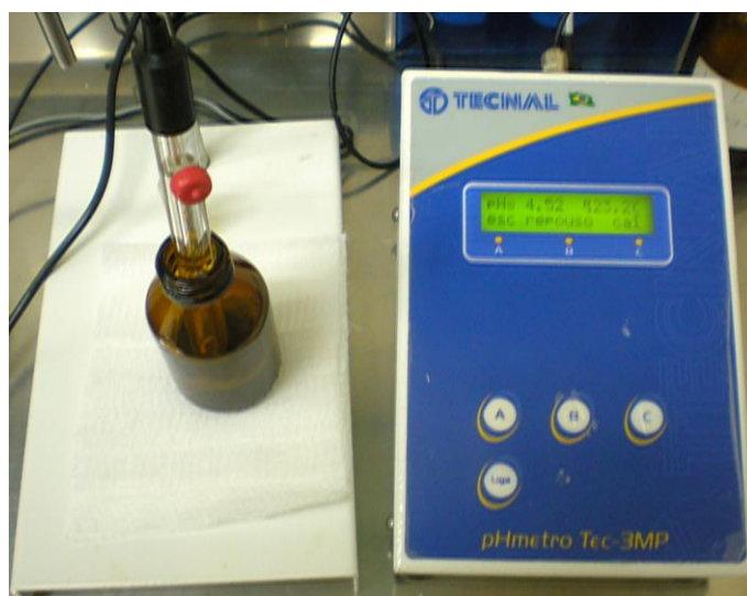
Figura12 - Obtendo o valor do pH do extrato.
