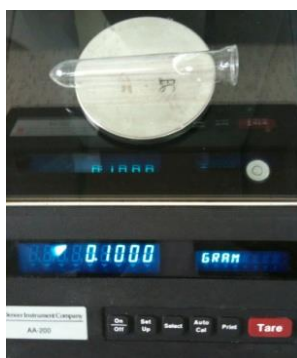
Figura 5 – Pesagem de 100 miligramas de dentifrício em balança de precisão eletrônica.
