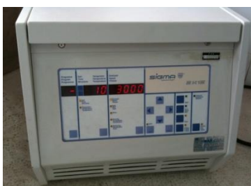
Figura 8 – Centrifugação da suspensão durante 10 minutos a 3000 rpm.
