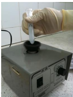
Figura 6 – Agitação da solução dentifrício mais água deionizada.
