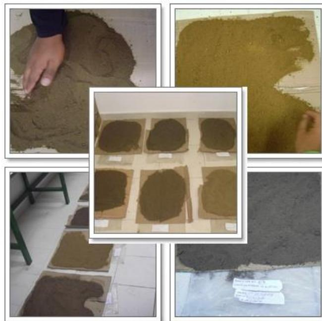
Figura 5: Procedimentos de destorroamento e secagem ao ar das amostras utilizadas.
