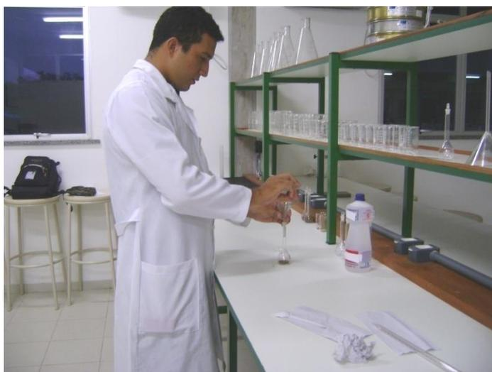
Figura 6: Procedimento realizado para a determinação da densidade real segundo o método do balão volumétrico indicado pela EMBRAPA (1997).
