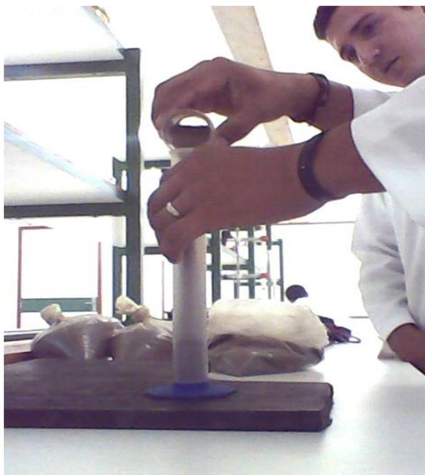
Figura 7: Procedimento realizado para a determinação da densidade aparente segundo o método da proveta.
