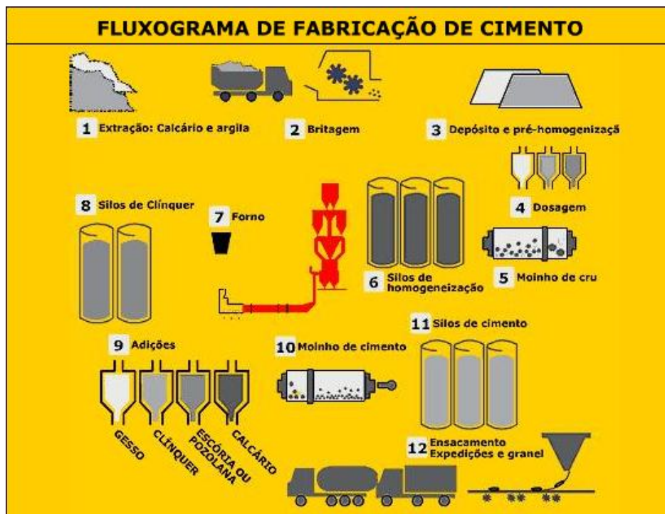
Figura 1 - Processo de produção de cimento.
