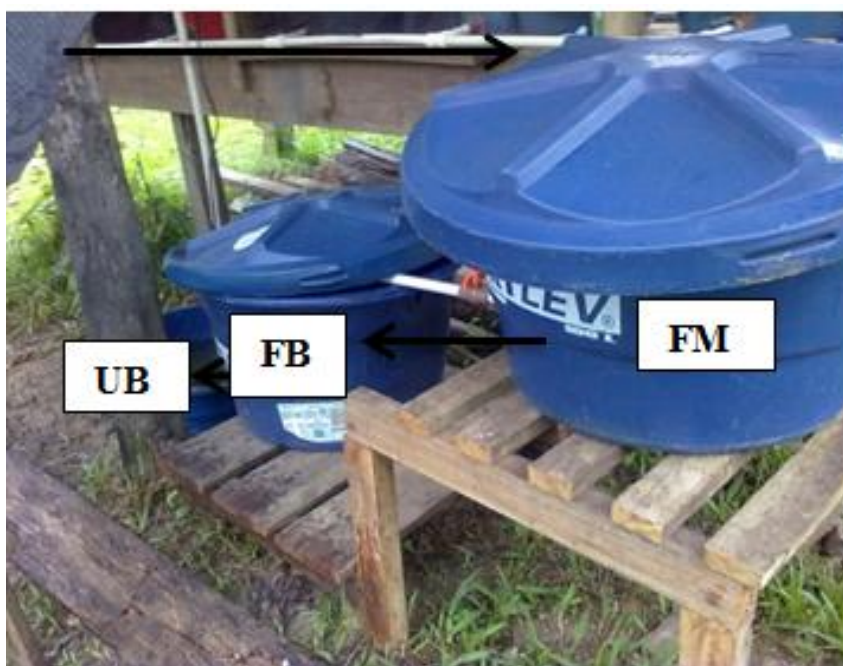
Figura 1-Fluxo de drenagem das unidades experimentais para o FM (Filtro mecânico) e FB (filtro biológico), por gravidade
