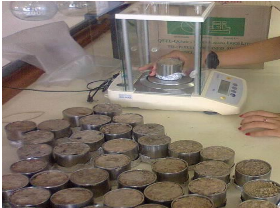
Figura 04: pesagem do solo para determinação da densidade do solo
