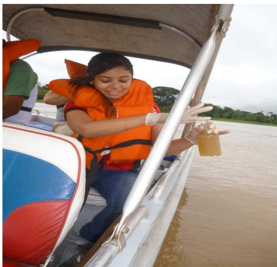
Figura 8: Coleta em campo realizada para análise do oxigênio dissolvido, calha central montante de Humaitá-AM.
