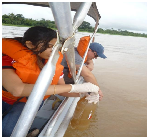
Figura 7: Coleta para análise laboratorial (pH e condutividade), calha central montante de Humaitá-AM.
