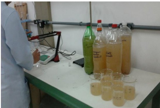
Figura 12: Análise do pH, realizadas com amostragens dos 6 pontos de coleta, UFAM, Humaitá-AM.
