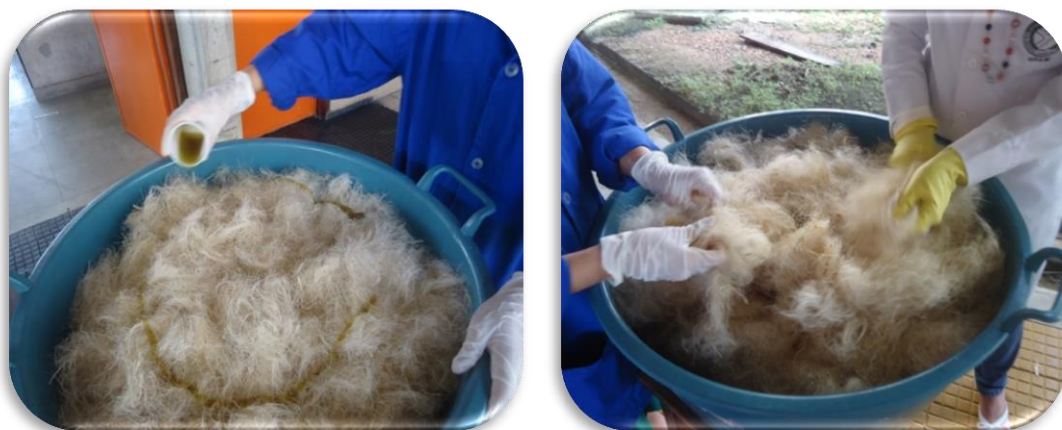
Figura 08. Mistura da resina nas fibras.
