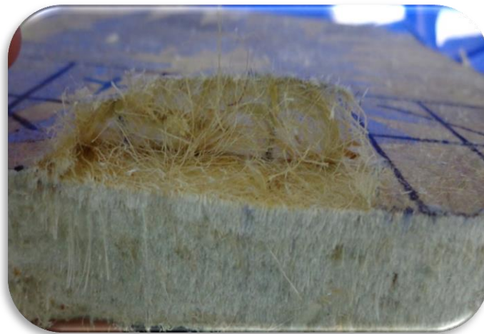
Figura 13. Compósito polimérico de resina poliuretano à base da mamona e fibra de curauá.
