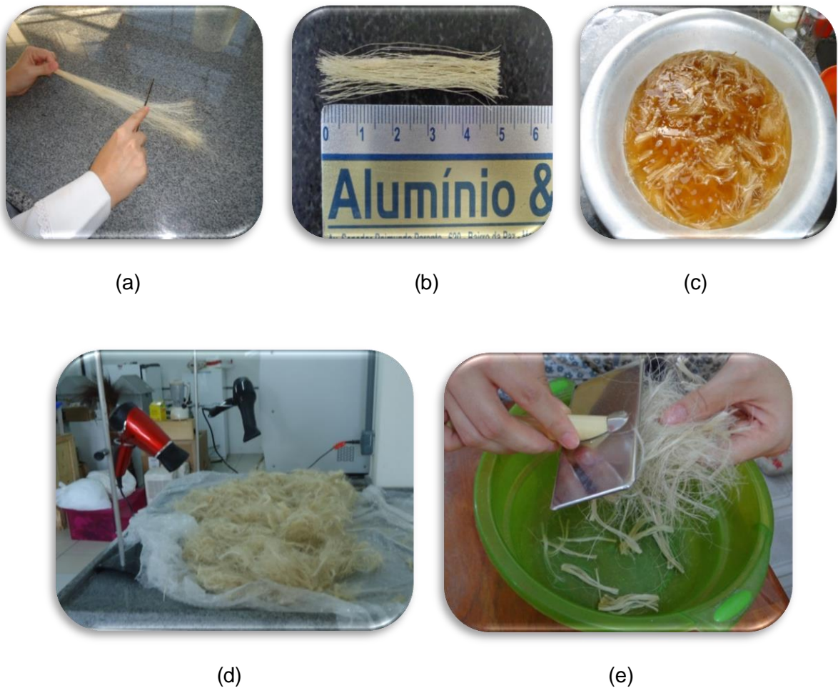
Figura 07. (a) Desemaranhamento; (b) Corte; (c) Lavagem; (d) Secagem; (e) Desfibrilamento manual.
