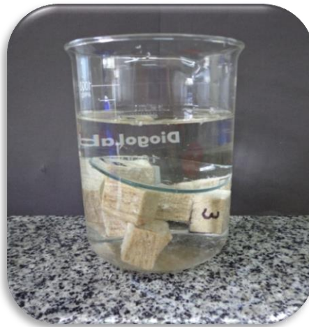
Figura 12. Ensaio de Absorção e Inchamento.
