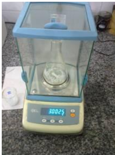
Figura 3.2: Pesagem do soluto- Fonte: próprio autor 2012
