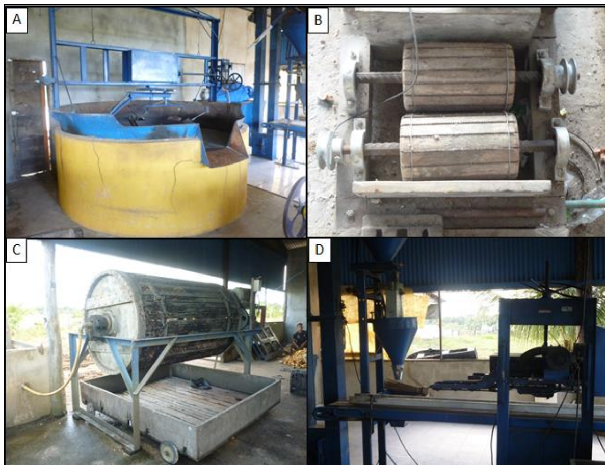
Figura 7: A- Forno elétrico. B- Equipamento utilizado para manter o padrão dos grãos de farinha. C- Descascador de mandioca. D- Máquina empacotadora.
