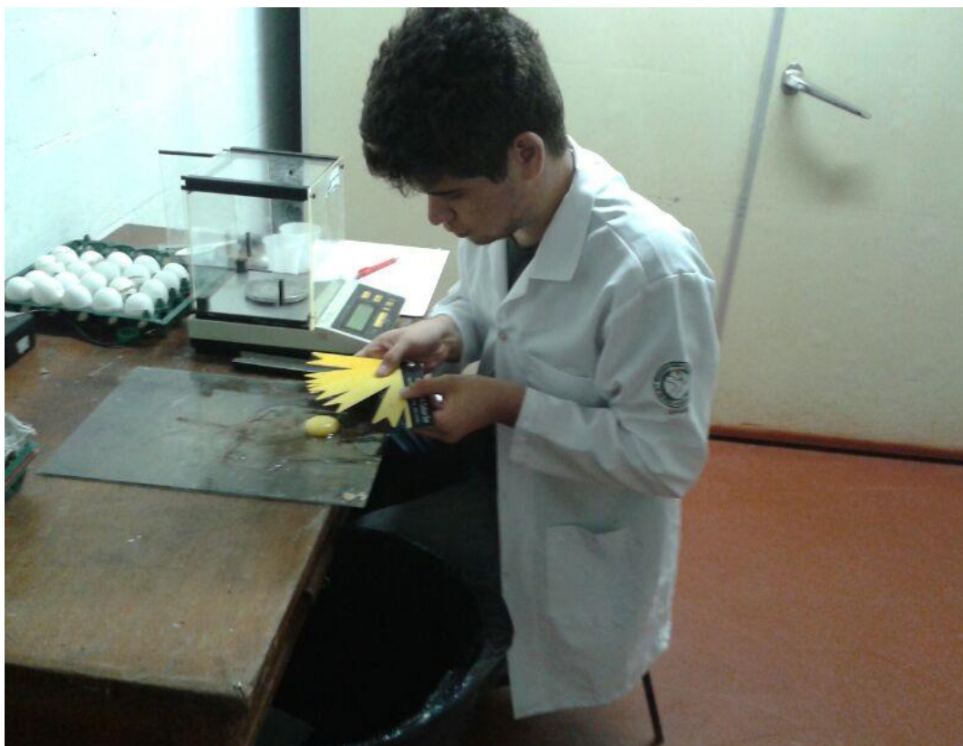
Foto 4 – Análise de pigmentação da gema através da utilização de leque colorimétrico da marca Roche. Fonte: RUFINO, J. P. F. (2013).
