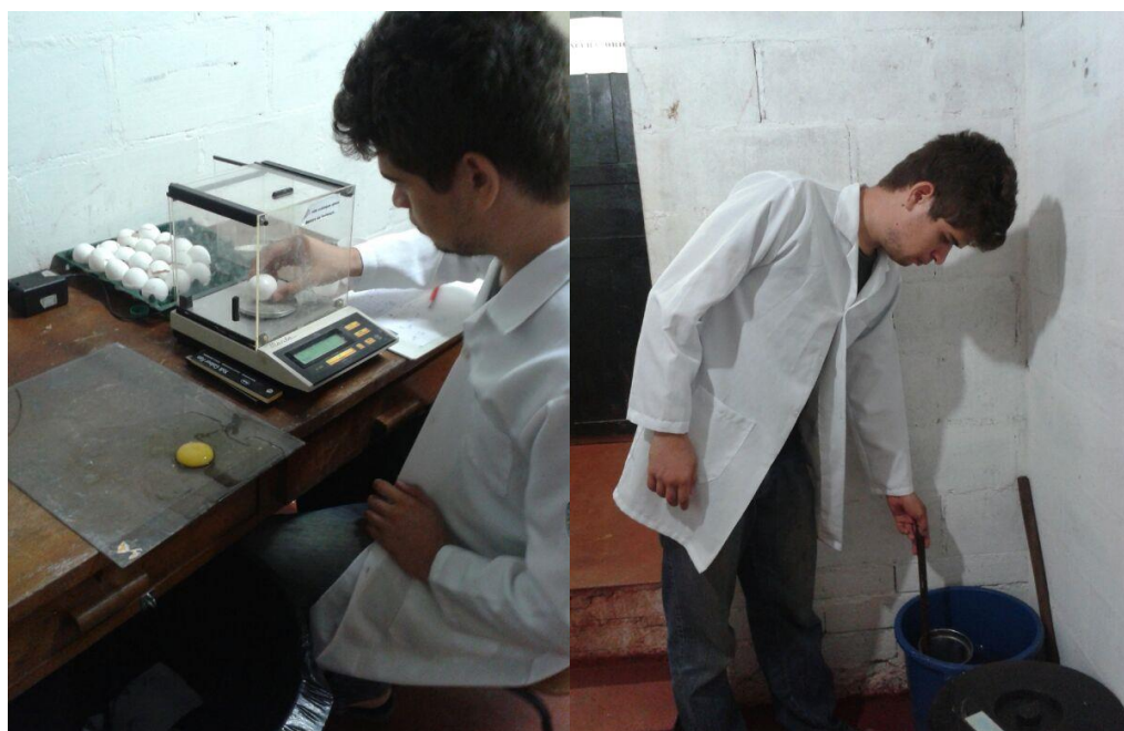
Fotos 2 e 3 – Mensuração de peso e gravidade específica dos ovos. Fonte: RUFINO, J.P.F. (2013)
