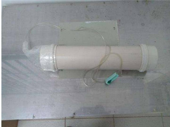
Figura 4 - Modelo do silo experimental
