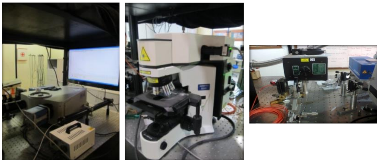
Figura 2 - (a) Espectrômetro Jobin Yvon modelo iHR550; (b) Microscópio Jobin Yvon modelo iHR550; (c) Montagem do aparato experimental.
