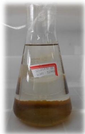
Figura 11 – Silicato oxidado extraído durante 2 horas a 60°C
