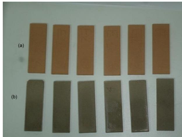
**Figura 9.** (a) Corpos de prova sinterizados e (b) corpos de prova secos.
