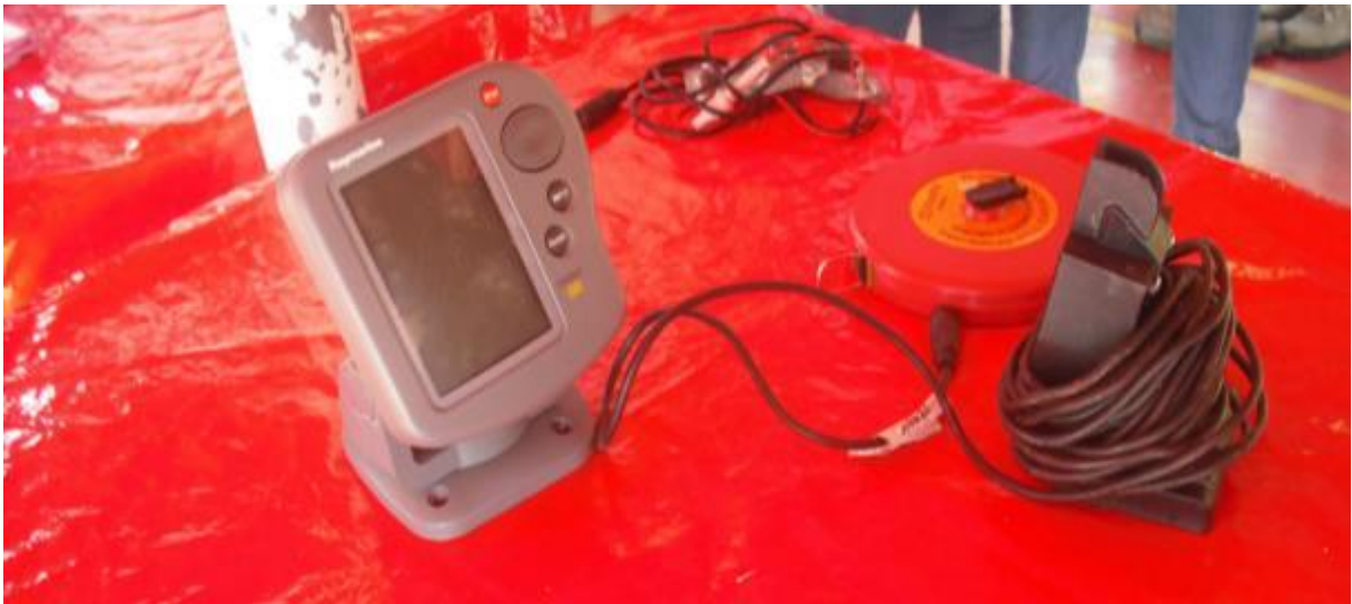
Figura 07: Ecobatímetro, equipamento utilizado nos procedimentos de batimetria realizados durante o trabalho de campo, Foto: Evelyn Ribeiro/ 2014.
