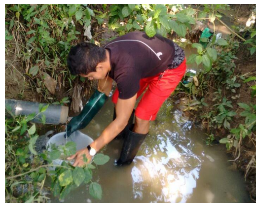
Figura 4. Medição da vazão nos tubos, em balde milimetrado, utilizando o método volumétrico.
