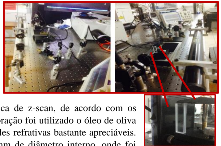
Figura 3: esquema experimental do z-scan, ao lado a legenda. Abaixo a montagem real da técnica z-scan. Mostrando a cubeta de quartzo.
