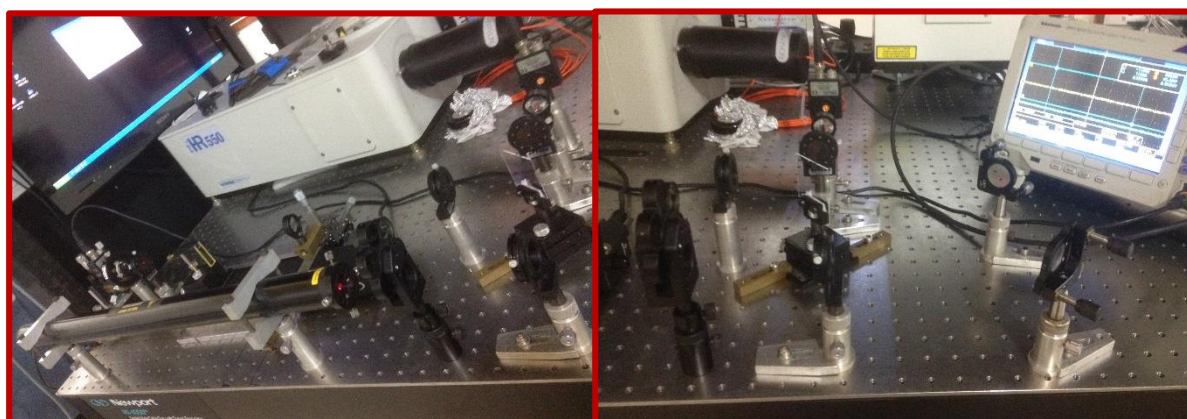
Figura 8: medidas com a técnica z-scan totalmente montada
