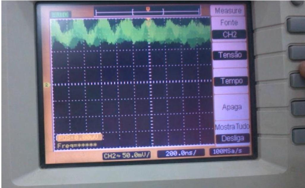
Figura 4 - Onda gerada na saída do 555.
