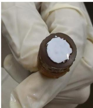
**Figura 3: Corpo-de-prova com tinta sem nanopartículas.**
