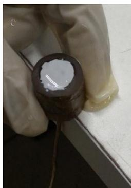
**Figura 4: Corpo-de-prova com tinta com nanopartículas.**
