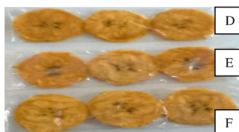
Figura 3: Filme controle (D), filme a 3% com volume (AC 75 \mu L + AA 75 \mu L) (E), (AC 112,5 \mu L + AA 112,5 \mu L) (F).
