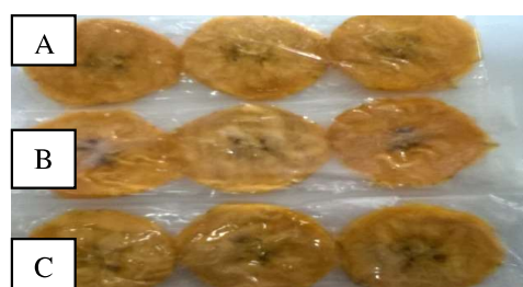
Figura 2: Filme controle (A), filme a 2% com volume (AC 75 \mu L + AA 75 \mu L) (B), (AC 112,5 \mu L + AA 112,5 \mu L) (C).
