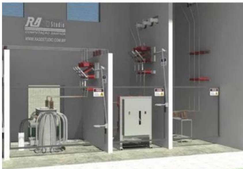
Figura 33 - Posto de proteção primária (compartimento ao meio).
