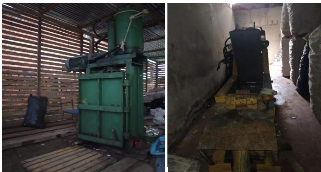
Figura 12: Prensa hidráulica utilizada no processo de compactação.
