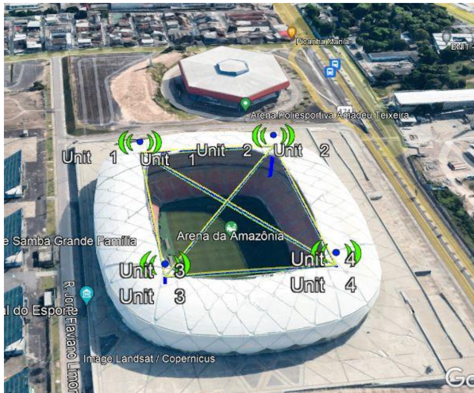
Figura 51 – Projeto Completo da Rede LTE na Arena da Amazônia feito no Radio Mobile e visualizado no Google Earth. Fonte: Autor.
