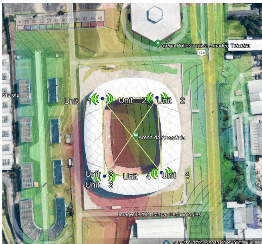
Figura 50 – Arena da Amazônia com a Rede e Relevos no Radio Mobile. Fonte: Autor.
