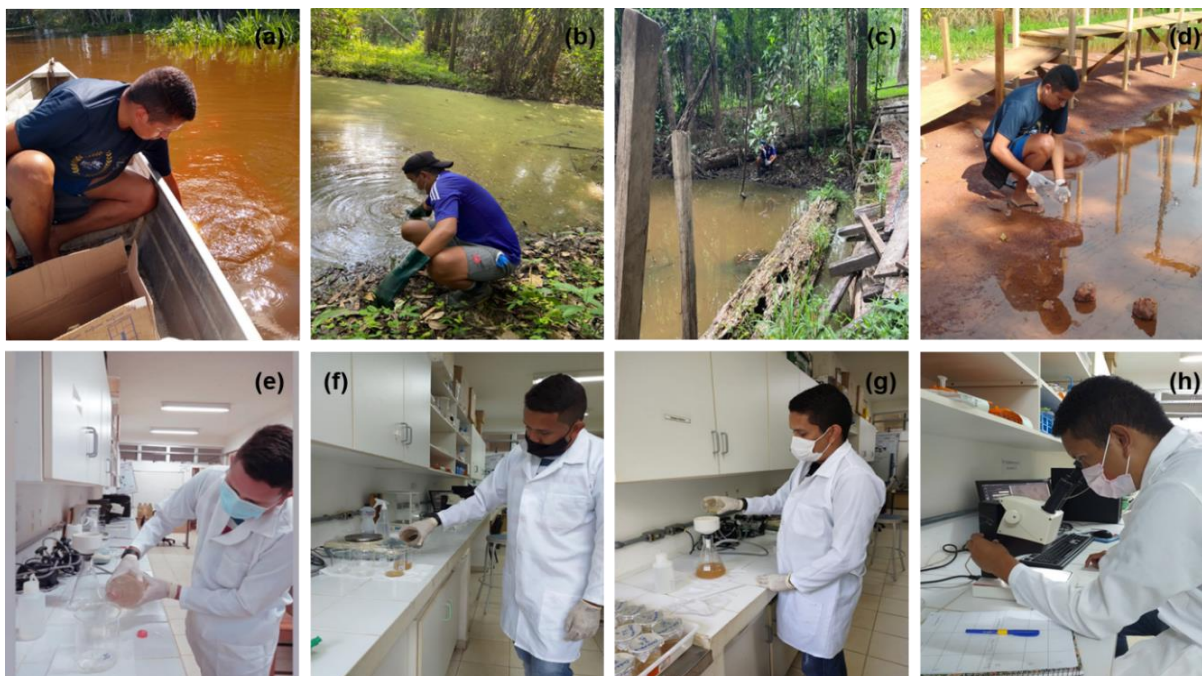
Figura 2- Etapas de coletas, preparação dos materiais e identificação dos MPs. Coleta de águas superficiais (período cheia) (a). Coleta de águas superficiais (período seca) (b). Coleta de sedimentos (período seca) (c). Coleta de sedimentos (período cheia) (d). Preparação das amostras de águas superficiais (e). Preparação das amostras de sedimentos (f). Preparação das amostras de sedimentos (g). Análises das amostras (h).
