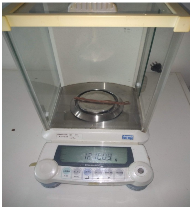
Figura 17 - Visão geral da balança de precisão empregada no experimento, observando no display do equipamento a leitura de 12,1009 g do quantitativo inicial de fio de cobre, primeira foto da esquerda para direita. Aumento do quantitativo para 36,4637 g na foto da direita para a esquerda.
