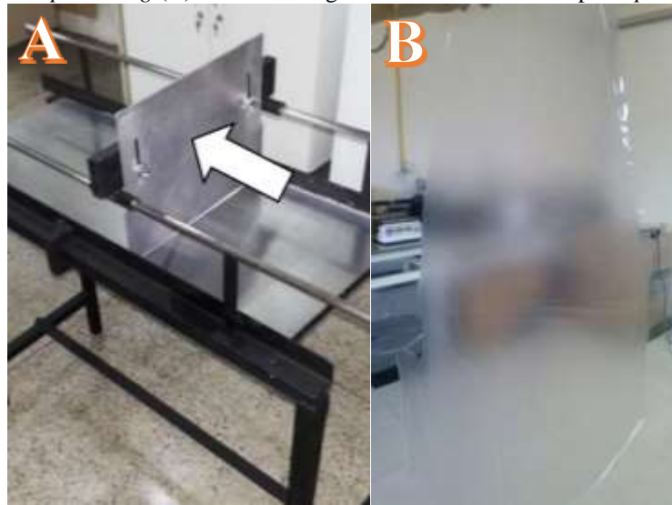
Figura 6 – Tape-casting (A) e filme biodegradável de amido nativo por tape-casting (B)
