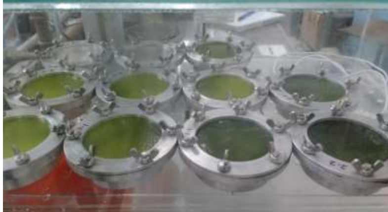
Figura 8 – Células de alumínio para análise de permeabilidade ao vapor de água
