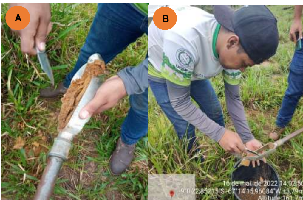
Figura 6. Corte de limpeza e seleção da parte central da amostra simples; (B) Parte central da amostragem simples sendo coletada e armazenada no balde, para a formação da amostra composta
