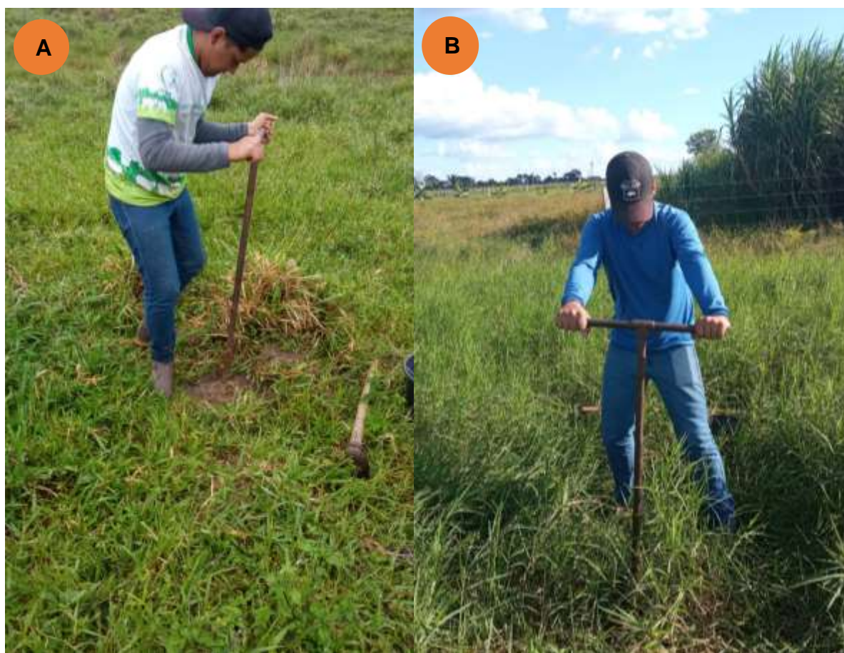
Figura 5. Limpeza da área do ponto de coleta, e coleta do solo utilizando o trato holandês (A e B).
