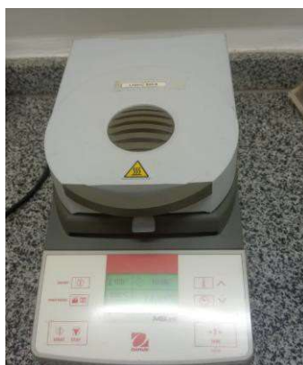
Figura 12: Teste de umidade
