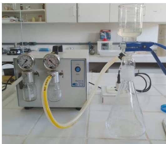
Figura 6 -Sistema de filtração com bomba a vácuo
