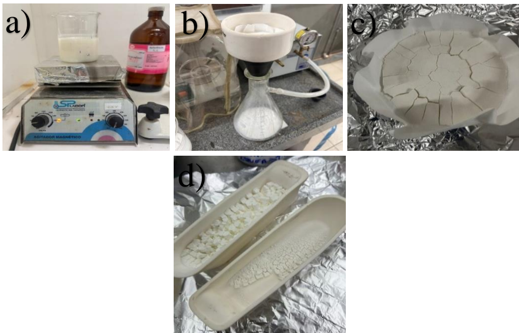
Figura 23 – Processos do Método Sol-gel para obtenção de titânia
