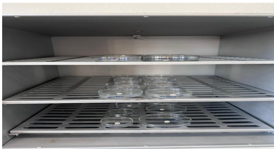
Figura 30- Amostras secas em estufa por 4hrs e 100° C.
