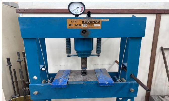
Figura 26- Prensa hidráulica utilizada para confecção das pastilhas
