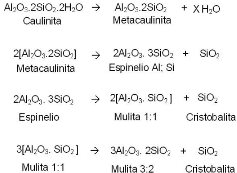
Figura 3 - Reações Químicas da Caulinita sob influência da temperatura. Fonte: Alatrística, 2008.
