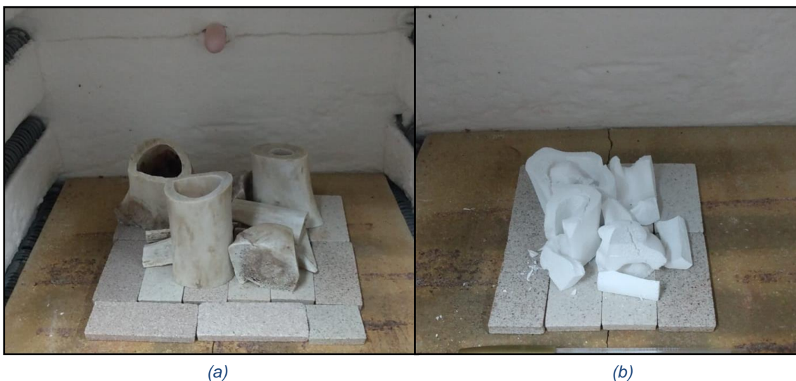
Figura 10 - Ossos bovinos (a) antes da calcinação (b) após calcinação a 1000°C. Fonte: Do autor.
