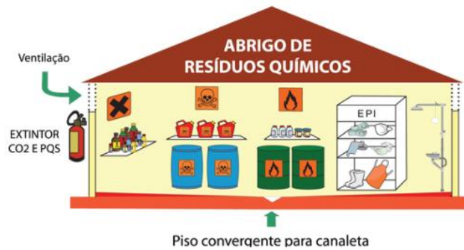
Figura 5 - Abrigo externo dos RSS do grupo B.
