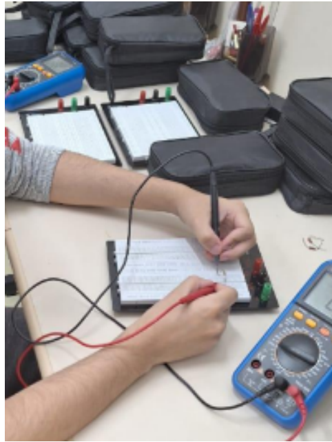
Figura 3.26 – Teste de continuidade dos multímetros
