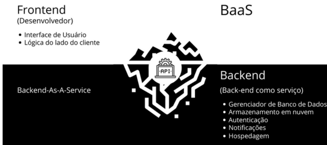
Figura 6. Integração backend e frontend utilizando um Baas. Fonte: Treina Web, 2020.
