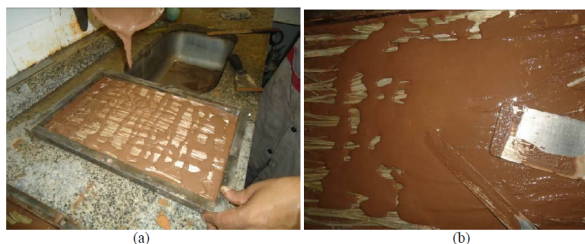
Figura 41 - Moldagem das placas: (a) Colocação de uma das camadas de argamassa sobre as fibra (b) Espalhamento da argamassa na forma.
