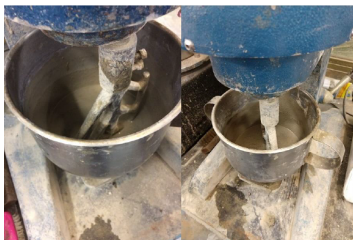
Figura 34 - Mistura e produção da argamassa
