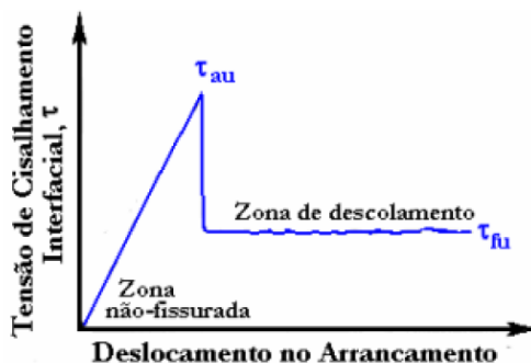
Figura 17 - Representação das tensões tangenciais de cisalhamento na interface da fibra-matriz.
