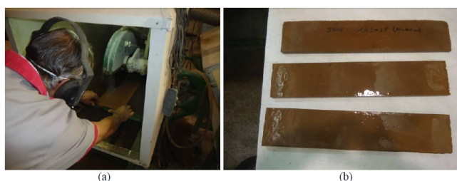
Figura 42 - Preparação das placas para ensaios mecânicos: (a) corte das placas, (b) Amostras para ensaio de flexão.
