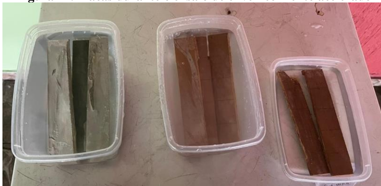
Figura 14. Placas durante o ensaio de envelhecimento acelerado
