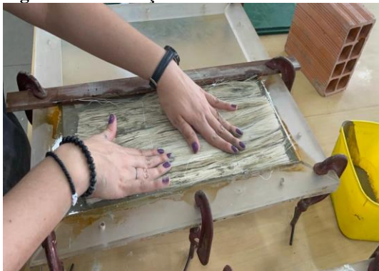
Figura 10. Colocação da camada de fibra
