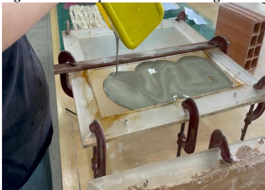
Figura 8. Colocação da camada de argamassa
