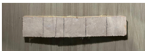
Figura 5. Ocorrência de fissuras na região inferior dos corpos de prova.
