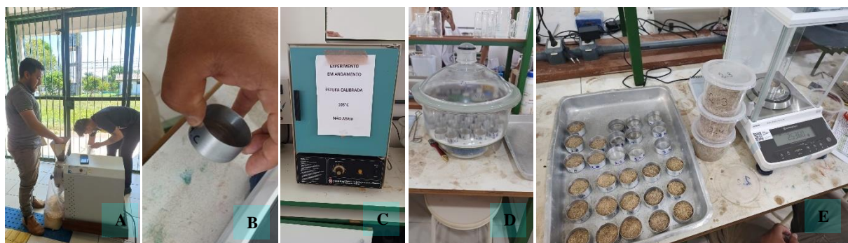
Figura 5. Materiais para análise de %MS. (A) Trituração em moinho; (B) Capsula; (C) Estufa de 105°C; (D) Dessecador e (E) Amostras secas e pesadas.
