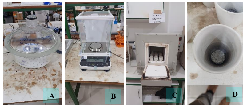
Figura 6. Materiais para análise de %MM. (A) Dessecador; (B) Balança analítica; (C) Mufla e (D) Cinzas.
