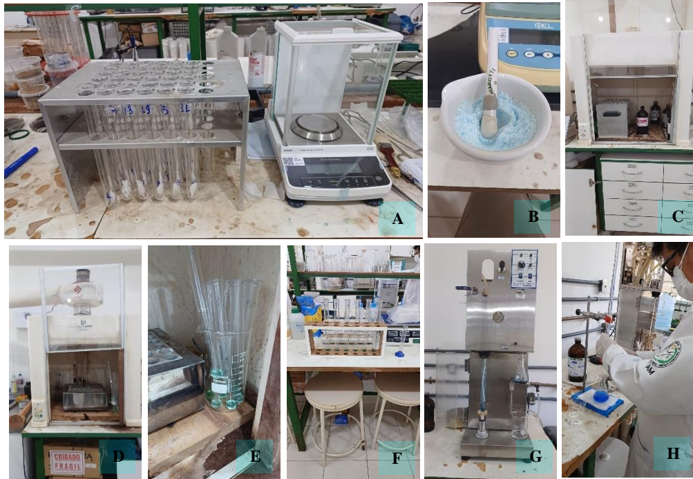
Figura 7. Materiais utilizados para análise de %PB. (A) Amostras pesadas no tubo de ensaio; (B) Mistura catalítica (Sulfato de Potássio + Sulfato de Cobre); (C) Capela (introdução de 5 ml de ácido sulfúrico); (D) Bloco Digestor e Capela; (E) e (F) Amostras digeridas; (G) Destiladora (Destilando amostras); (H) Processo de titulação
