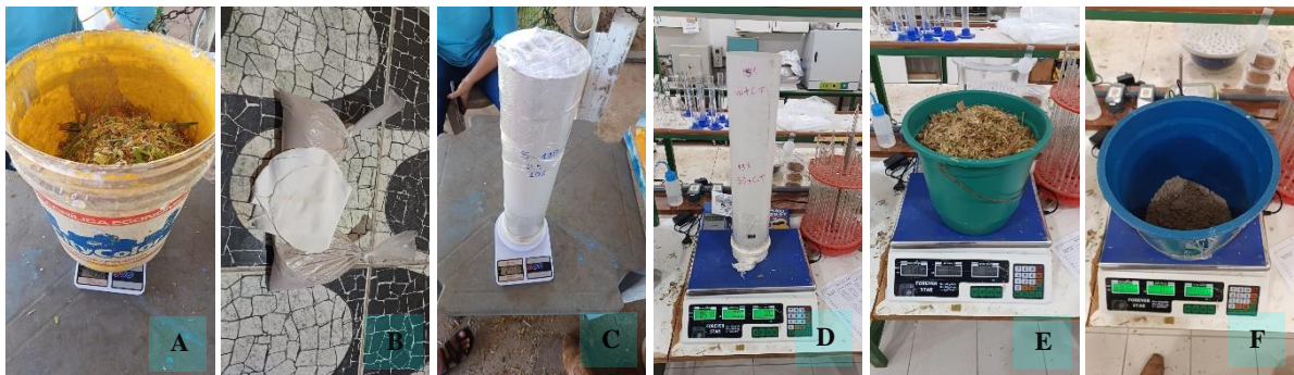
Figura 3. Peso antes e depois do material para cálculo de Perdas por Gases; Perdas por Efluentes e Recuperação de Matéria seca. (A) Pesagem da forragem ensilada; (B) Areia e pano; (C) Peso silo antes; (D) Peso silo após os 30 dias; (E) Peso da Silagem e (F) Peso da areia e pano.
