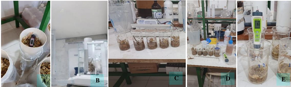
Figura 4. Procedimento de avaliações da estabilidade aeróbia; pH e T°C. (A) Aferição da estabilidade aeróbia (T°C) a partir do momento em que a silagem ficou exposta ao ar durante 96 horas; (B) Pesagem da amostra da silagem para processo de medição do pH e T°C; (C) Amostra homogeneizada com adição de 60ml de água destilada; (D) Amostras homogeneizadas e materiais utilizados na medição do pH e T°C e (E) Aferição do pH e T°C da amostra da silagem.
