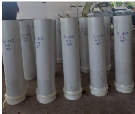
Figura 1 - Silos experimentais confeccionados com tubos PVC.
