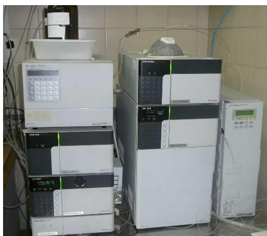
Figura 2: Sistema cromatográfico HPLC usado para dosar o malondialdeído (MDA).
