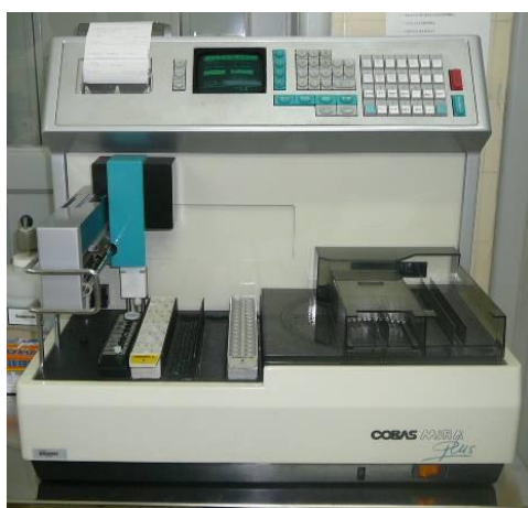
Figura 1: Aparelho COBAS MIRA® usado para dosagem do Ácido Úrico.
