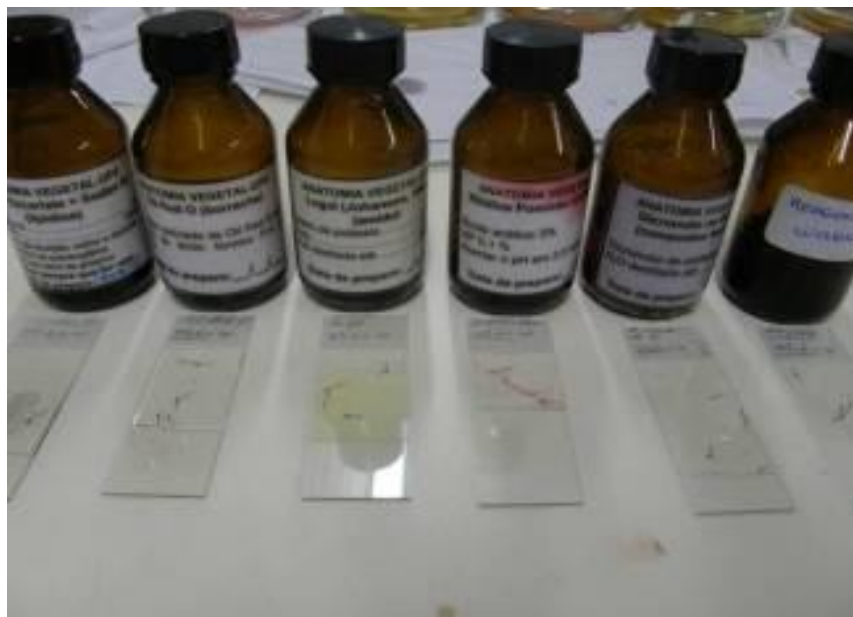
Figura 2 – Reagentes (da esquerda para a direita): Sudan IV, Oil Red O, Lugol, Xilidine Ponceau, dicromato de potássio, Wagner e suas respectivas lâminas.
