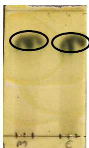
Figura 6: CCD revelada em cloreto férrico.
