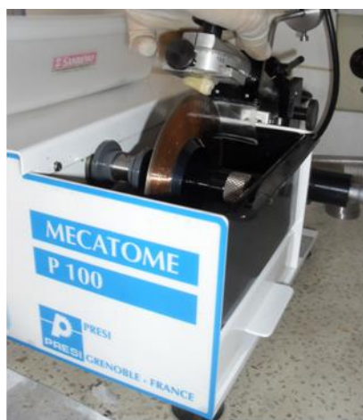
Figura 01 – dente posicionado na cortadeira com disco de diamante
