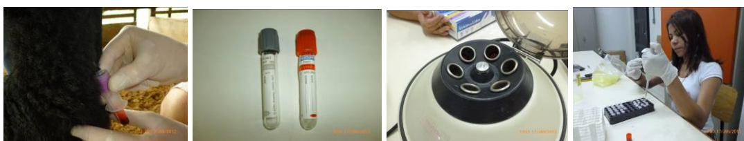
Figuras 4, 5, 6 e 7. Coleta de sangue por venopunção da jugular; tubos vacutainer com fluoreto e sem fluoreto de sódio; centrífuga utilizada no experimento e; transferência do soro para microtubos com capacidade para 0,5ml, respectivamente. Foto: SILVA, A.F., 2012.
