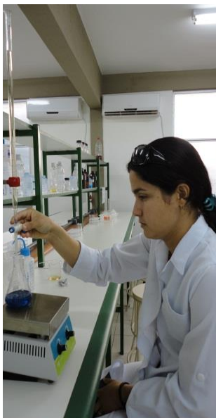
Figura 11: Padronização da solução de Fehling no início.
