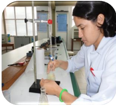
Figura 07: Titulação, para determinar acidez.
