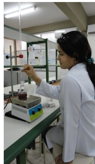
Figura 12: Final da padronização da solução de Fehling.
