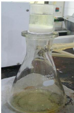
Figura 05. Ensaio de teor de celulose – Fonte: própria autora, 2012.
