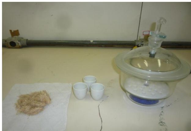
Figura 07. Ensaio de teor de cinza – Fonte: própria autora, 2012.
