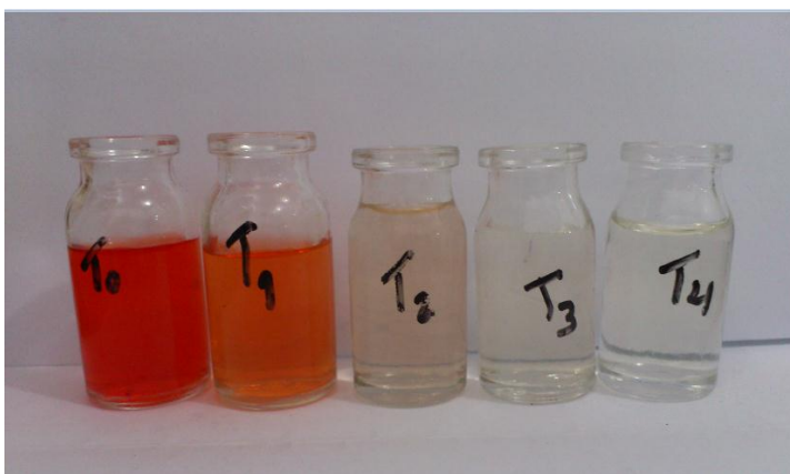
Figura 5.3 – Imagem da solução de RO16 eletrolisada à 20\text{mA}\cdot\text{cm}^{-2}
