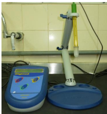
Figura 10. Peagâmetro digital do laboratório de Tecnologia farmacêutica da Faculdade de Ciências Farmacêuticas da Universidade Federal do Amazonas.
