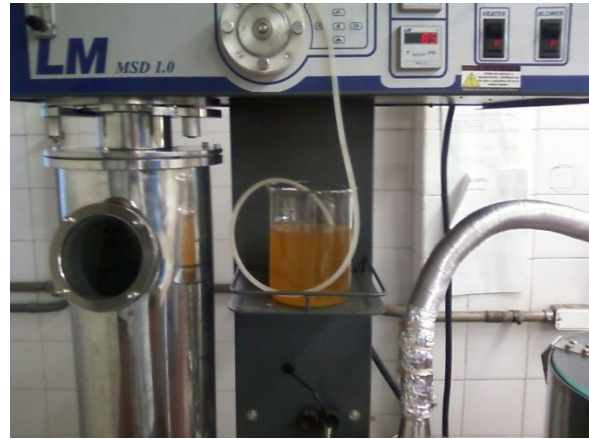
FIGURA 9. Extrato hidroalcoólico da semente da espécie vegetal Myrciaria dubia passando por secagem por aspersão em equipamento spray dryer .
