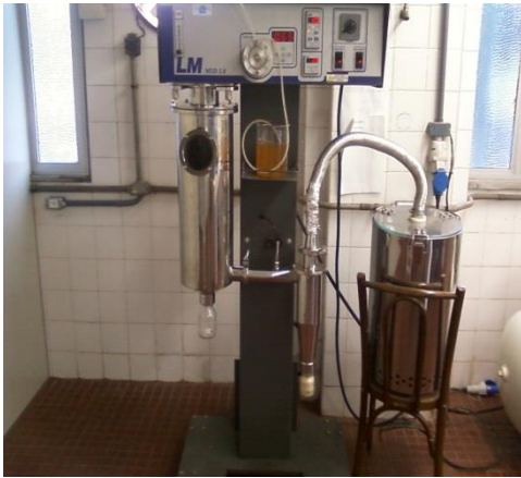
FIGURA 9. Extrato hidroalcoólico da semente da espécie vegetal Myrciaria dubia passando por secagem por aspersão em equipamento spray dryer .
